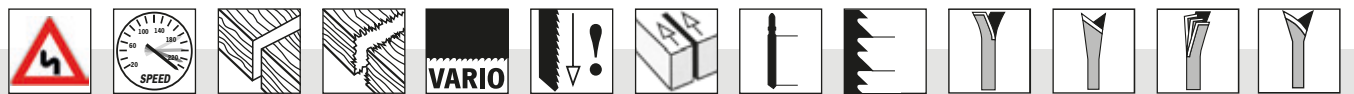
Kurven-schnitt Schneller Schnitt SPEED Feiner Schnitt Grober Schnitt Vario Verzahnung VARIO Zahnung auf Stoß Parallel-schnitt Schnitt-länge Anzahl Zähne pro Zoll/ Zahnabstand in mm Geschränkte Zahnung - grobe Schnitte Schräg geschärfte Zahnung - Blattkörper konisch - geschliffen präzise, saubere Schnitte Gewellte Zahnung - feine saubere Schnitte Geschränkte, schräg geschärfte Zahnung - grobe schnelle Schnitte
